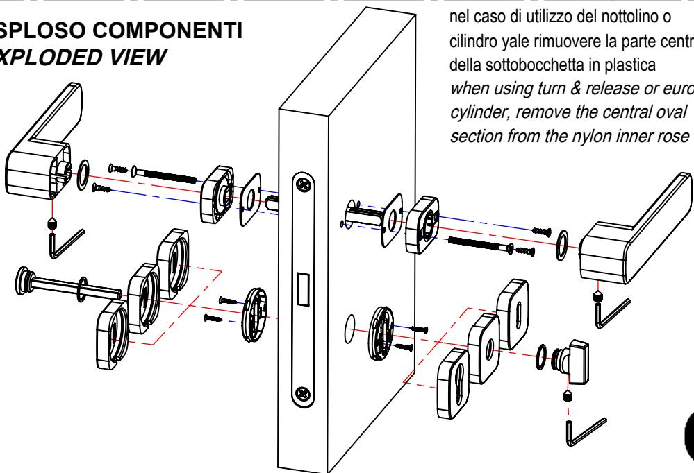
nel caso di utilizzo del nottolino o cilindro yale rimuovere la parte centrale della sottobocchetta in plastica
