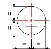
foro da eseguire nella porta rispettando la centratura con il quadro della serratura
