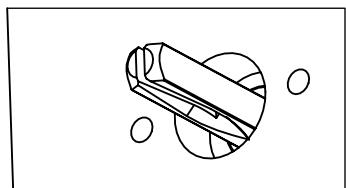
inserire il ferro quadro mantenendo la scanalatura verso il basso
