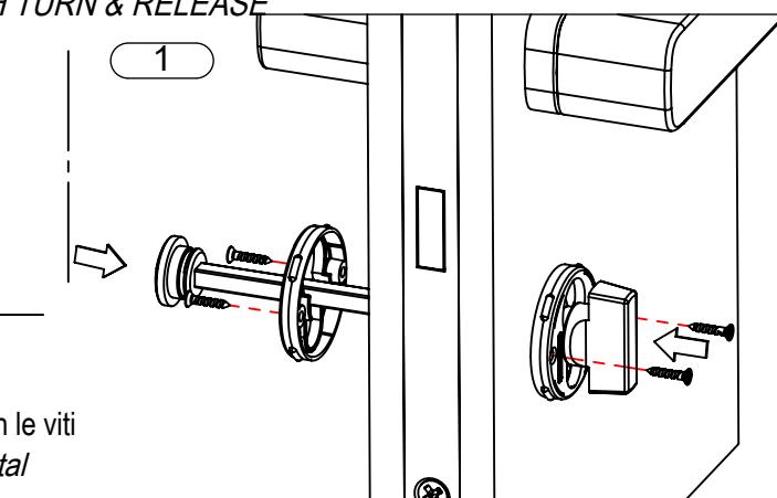
inserire il nottolino nella serratura per centrare le bocchette con la serratura e successivamente bloccarle con le viti
