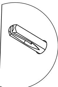
inserire il ferro quadro mantenendo la scanalatura verso il basso
