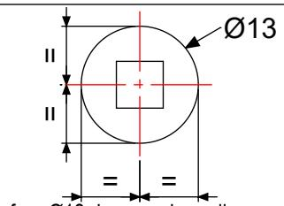
foro Ø13 da eseguire nella porta rispettando la centratura con il quadro della serratura
